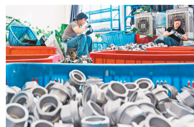
▲8月20日，重庆渝东阀门制造有限公司生产车间内，工人在分拣阀门零部件。
