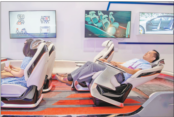
智能座舱展区展出的汽车智能座椅可在车内实现大幅度翻转、旋转与滑动。
