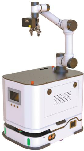
复合移动机器人是指由移动平台、操作机(以机械臂为主)、视觉模组、末端执行器等组成,利用多种机器人学,传感器融合定位与导航、移动操作、人工智能等技术,集成了移动机器人与操作机功能的新型机器人。相对于传统工业机器人,具有作业范围广,能集成更多功能、能串联更多工作环节的优势,满足当下柔性产线的生产需求。加大对云化复合移动机器人技术研究有助于推动行业技术发展。
