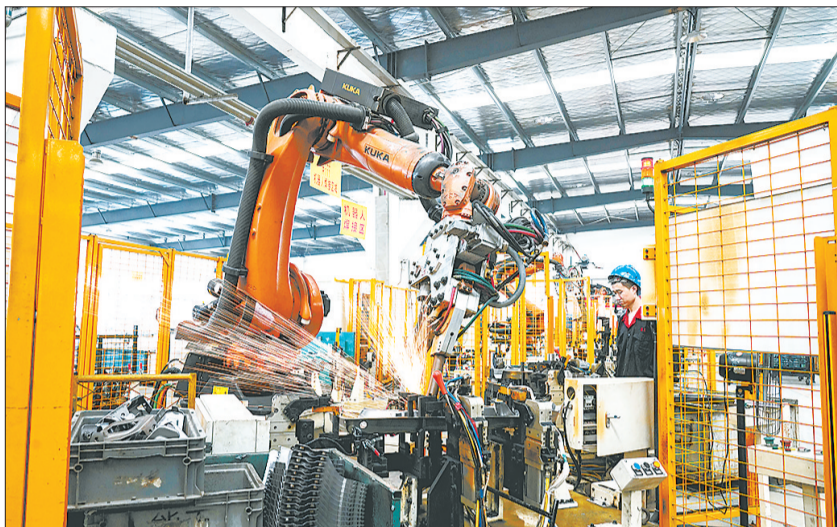
位于北碚区蔡家智慧新城的重庆能正机械有限公司厂房内,机器人在焊接汽车钣金件。 重庆日报特约摄影 秦廷富 摄
