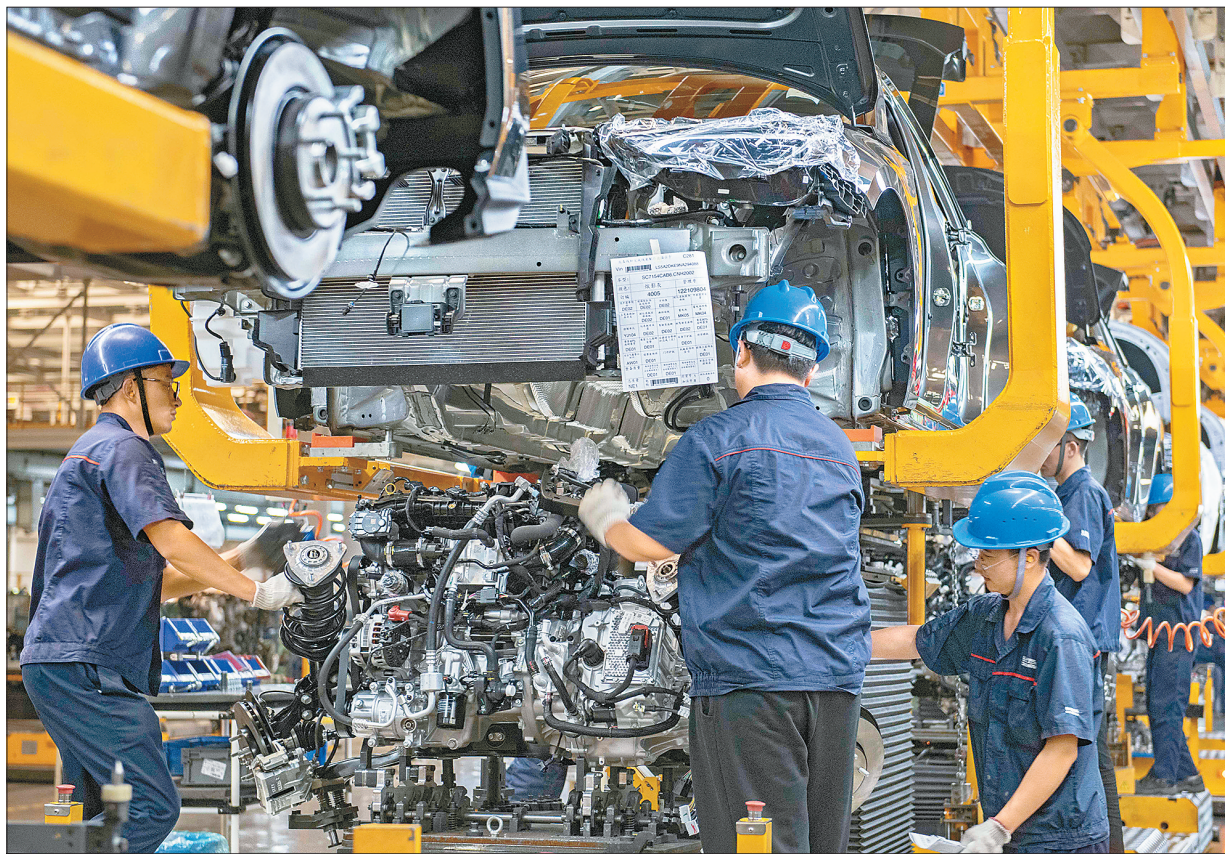
8月29日,在位于重庆两江新区的重庆长安两江工厂整装车间,工人们正在安装发动机。
