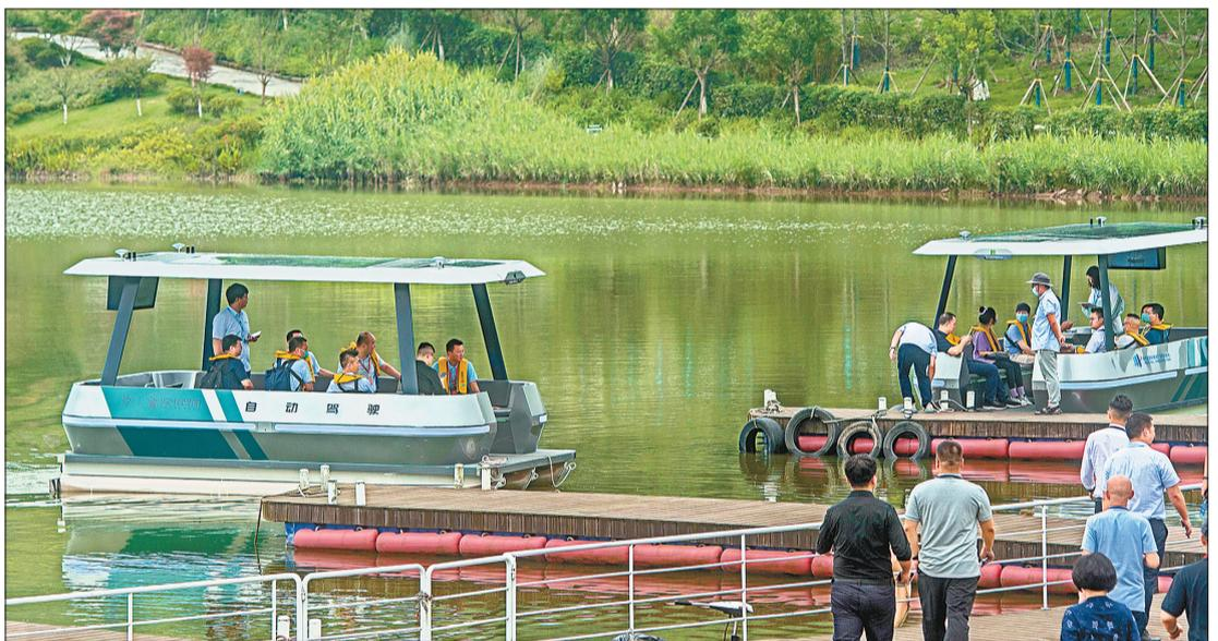
日前,一艘自动驾驶游船满载游客,在两江协同创新区明月湖完成首航。这艘由陕西欧卡电子智能科技有限公司研发的国内首艘L4级自动驾驶游船,具备自主导航、自主避障、自主泊岸、多雷达全向感知等功能。
