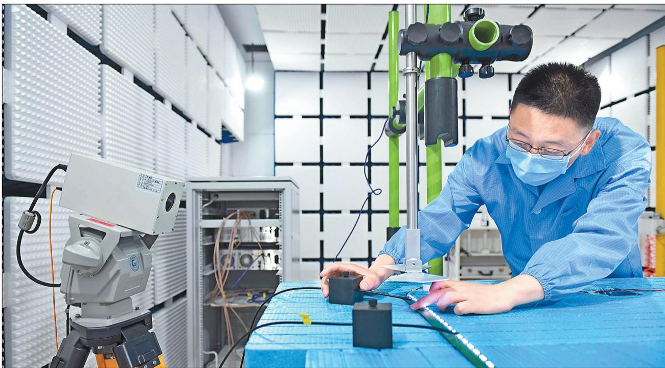
日前,重庆睿博光电股份有限公司,技术人员正在EMC电波暗室准备测试汽车氛围灯的抗干扰能力。
