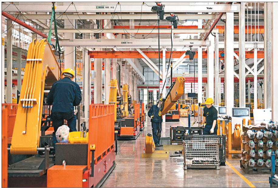
▲三一重机(重庆)智能制造生产线,工人正在生产挖掘机机械臂。
