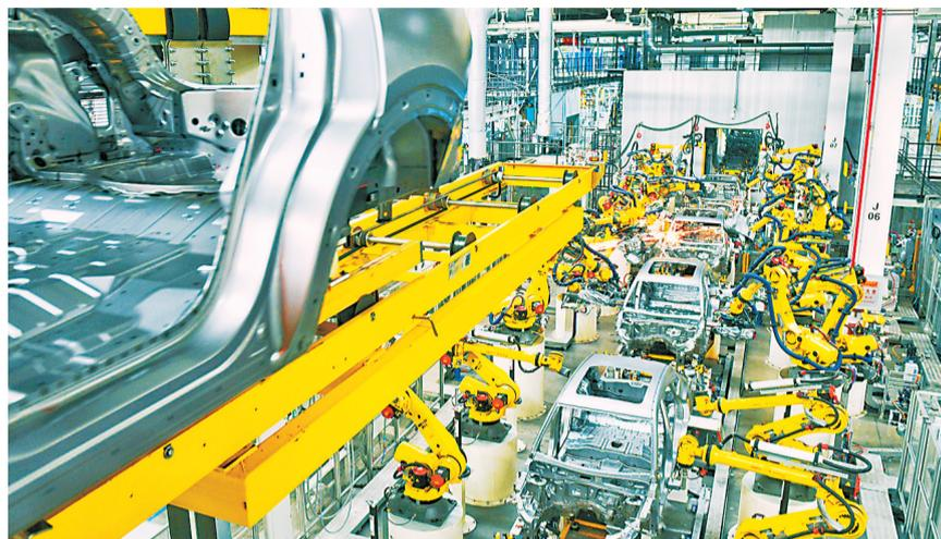
重庆金康新能源汽车智能工厂,焊接机器人正在焊接车身。
