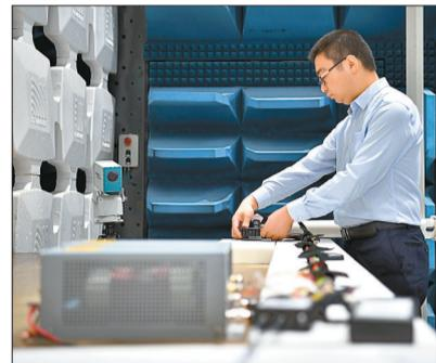
▲中国汽研EMC实验室,工程师正在测试验证手机电磁波是否会影响到汽车零部件正常工作。
