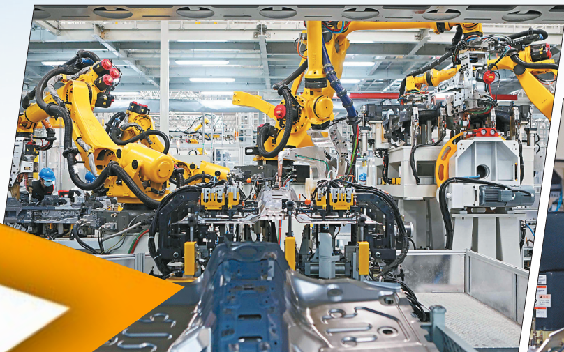
▲永川高新区凤凰湖产业园,长城汽车股份有限公司重庆分公司焊装车间,机器人对车身底盘进行焊接作业。 (本版图片均为重庆日报资料图片)
