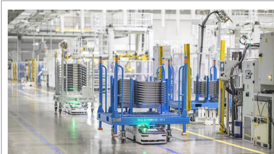
4月2日,在重庆金康赛力斯两江智能工厂焊装车间,AGV搬运机器人在车间内穿梭,将零部件及时转运至下一个流程点。
