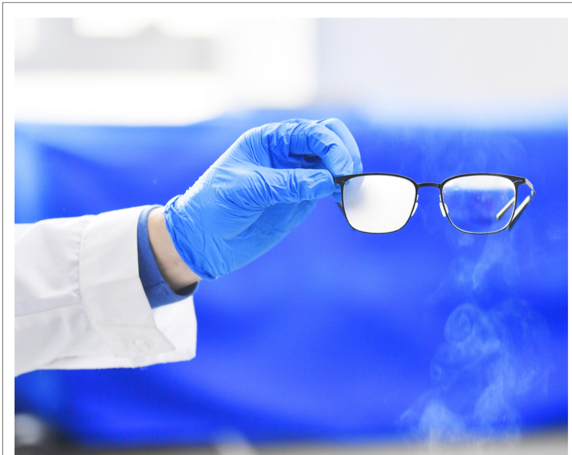
在清华大学天津高端装备研究院表面微纳技术研究所,实验人员展示研发成功的经亲水改性
