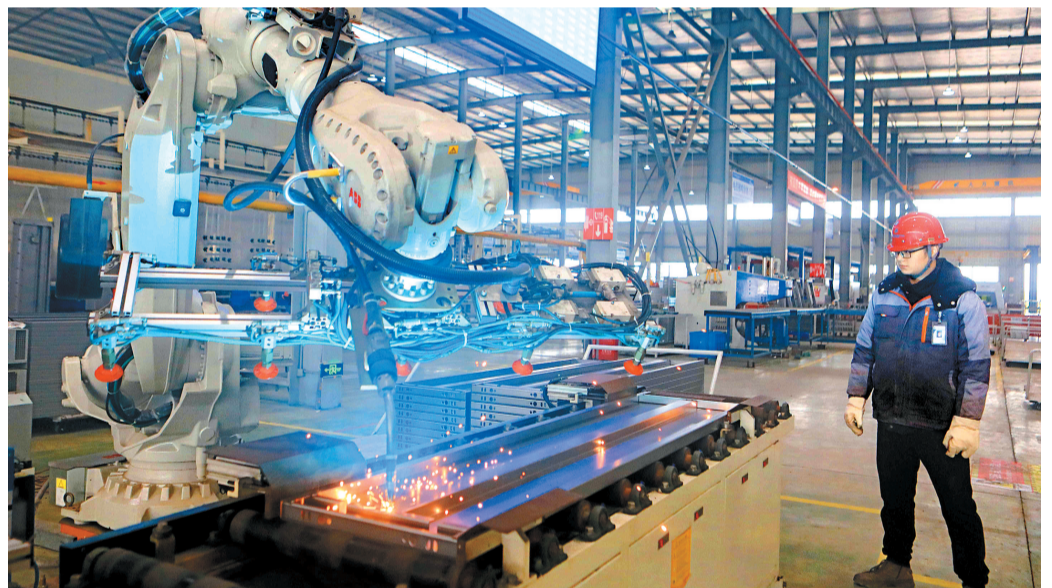
日前,位于大足高新区内的施密特电梯有限公司生产车间,瑞士ABB机器人生产线火力全开,每小时能生产30块电梯轿厢门板。
