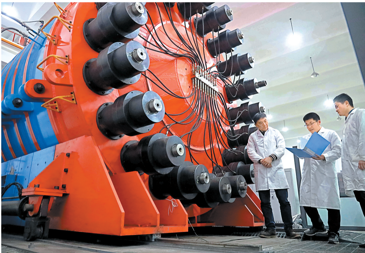
程多功 重庆大学煤矿灾害动力学与控制国家重点实验室,科研人员在深部煤岩工程多功能物理模拟试验系统开展工作。 重庆日报记者 卢越 摄
