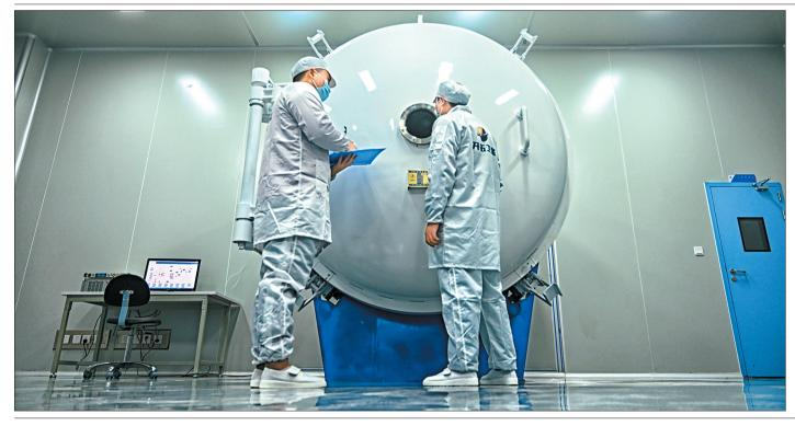
日前,綦江区,开拓卫星 试验工程师在对卫星电源产 品进行热真空实验。
