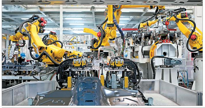
1月19日,永川高新区凤 凰湖产业园,长城汽车股份有 限公司重庆分公司焊装车间, 机器人对 WEY 坦克 300 车身 底盘进行焊接作业。
