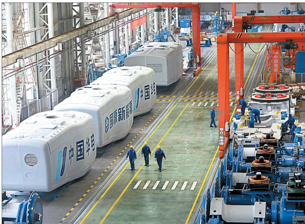
1月8日,位于两江新区礼嘉的中国船舶集团海装风电股份有限公司厂房内,技术人员正在紧张装配风电机组。
