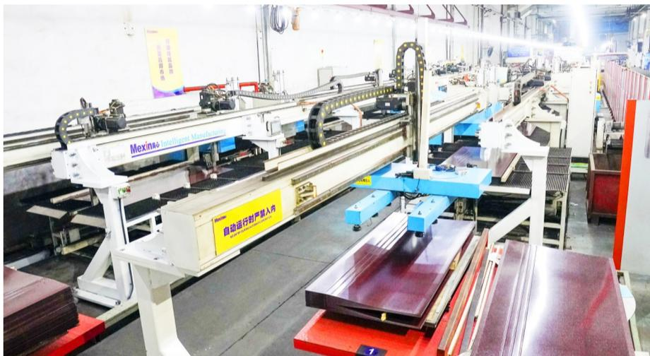
在传统制造业企业重庆美心集团的生产车间内,经过智能化改造的生产线上,300多台设备就像长了“眼睛”一样,扫描板材上的二维码,就能知道这块板材该如何加工。
