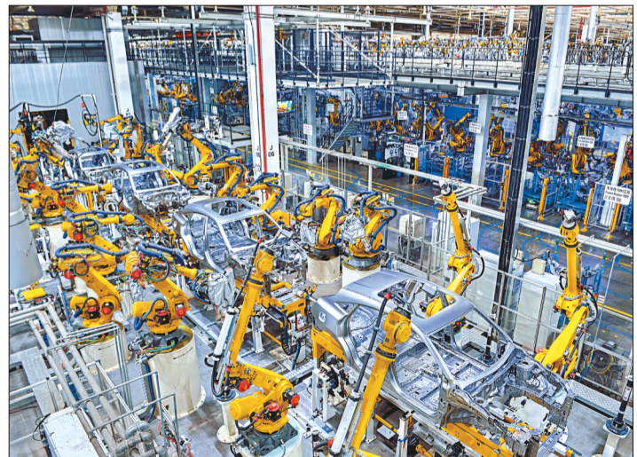
六月十八日,在位于两江新区鱼复园区的重庆金康两江智能工厂焊装车间,机器人有条不紊地在车身上忙碌。 重庆日报记者张锦辉摄
