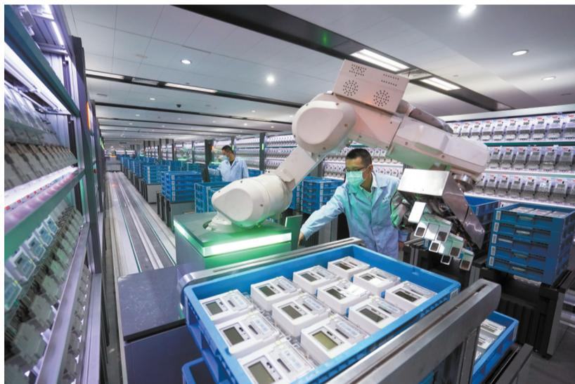
在江苏省能源计量中心(电力)的电能表智慧检测线上,技术人员、机器人各司其职,有序作业。据介绍,该中
