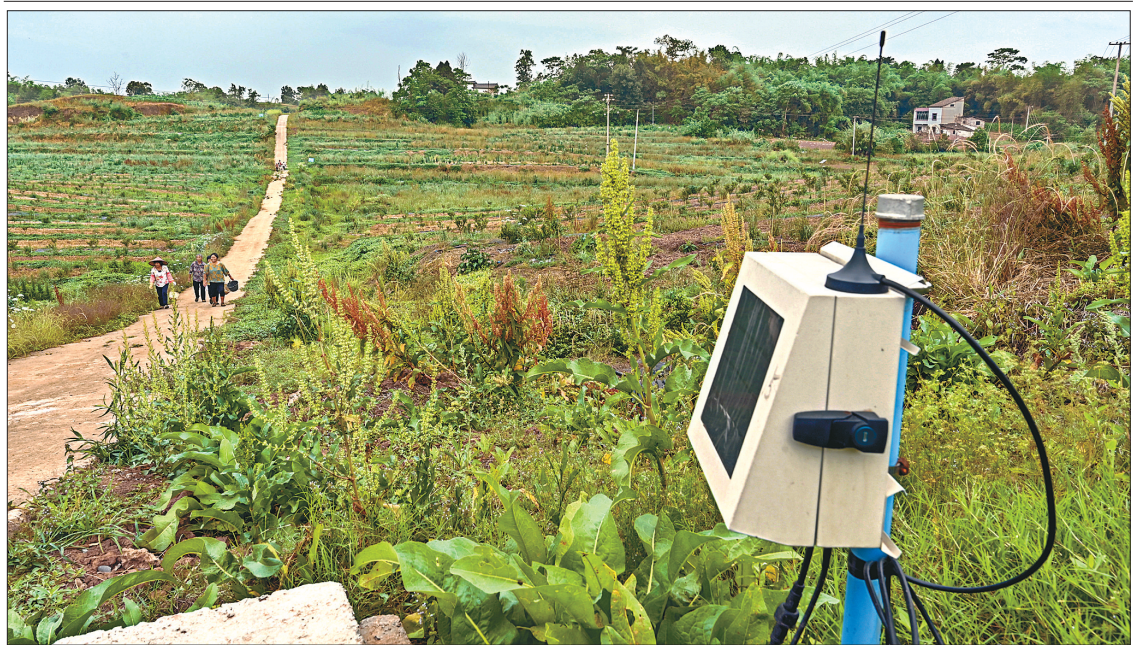
近日,合川区钱塘镇大柱村,安装在柑橘示范园里的无线阀门统控器,通过5G网络技术实施远程遥控施肥浇水。该果园已建成数字化农业生产管理系统、农业物联网系统、水肥一体化系统、智能虫情测报系统、农产品质量安全溯源系统、农产品市场价格行情研判系统,实现了柑橘现代化、智能化种植。
