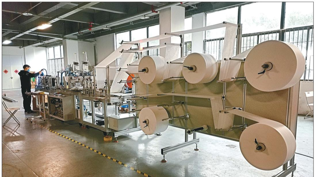
安木科技研发的KN95全自动口罩生产线。
