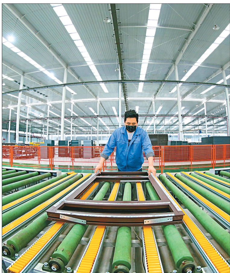
日前,万盛经开区平山产业园区,重庆高科幕墙门窗有限公司铝合金门窗自动化生产线,工人正在忙碌而有序作业。
