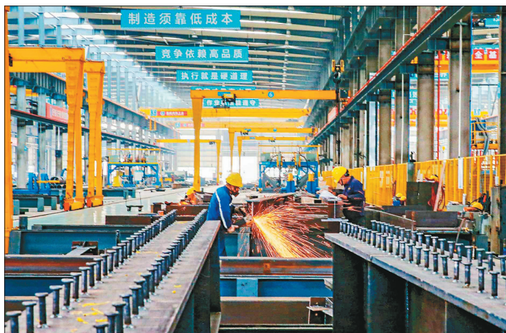
垫江高新区澄溪工业园内工人进行房屋建筑钢柱装配。重庆日报特约摄影 向晓秋
