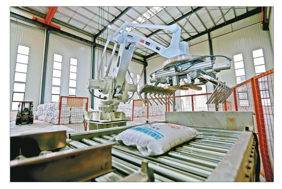
日前,万盛经开区平山园区的重庆良友耐火技 术有限公司不定形耐火材料自动化生产线,机械手 正在作业。
