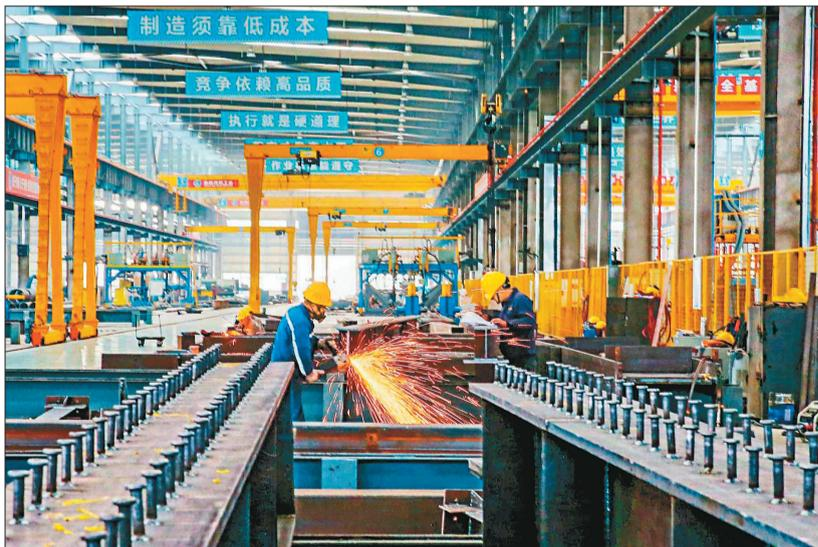
近日,在垫江高新区澄溪工业园国瑞绿色建筑产业园生产车间,工人进行房屋建筑钢柱装配。
