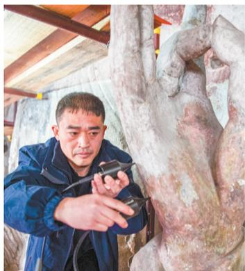
修缮工程技术人员在对造像进行表面弹性波检测。
