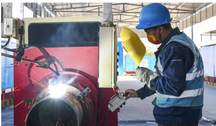
在西安电子科技大学广州研究院建设项目工地,工作人员操作悬臂式管道自动焊机。
