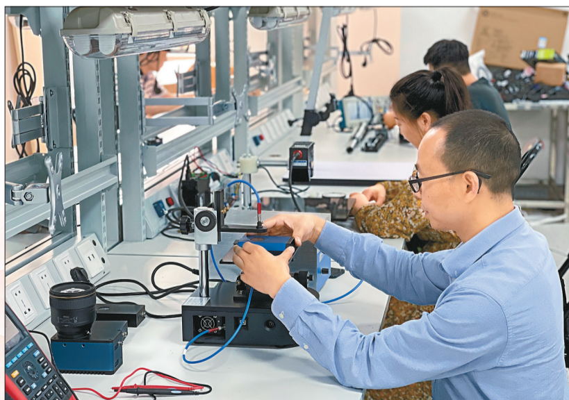
罗飞使用光纤光谱仪测试光谱调制器件。
