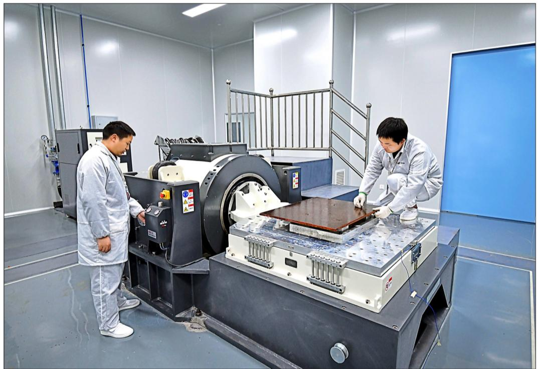
近日,重庆开拓卫星科技有限公司,工作人员正在进行太阳能电池阵电震动实验。
