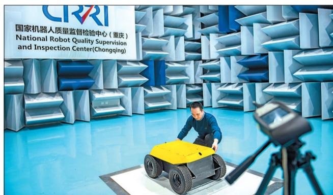
在国家机器人检测与评定中心(重庆),测试工程师在半消音室运用声级计评价一运输机器人的噪音值。
