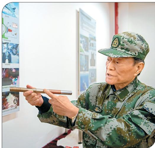
重庆机电职业技术大学兵器工艺研究所,孙智富教授展示用电刷镀复原的生锈钢管。
