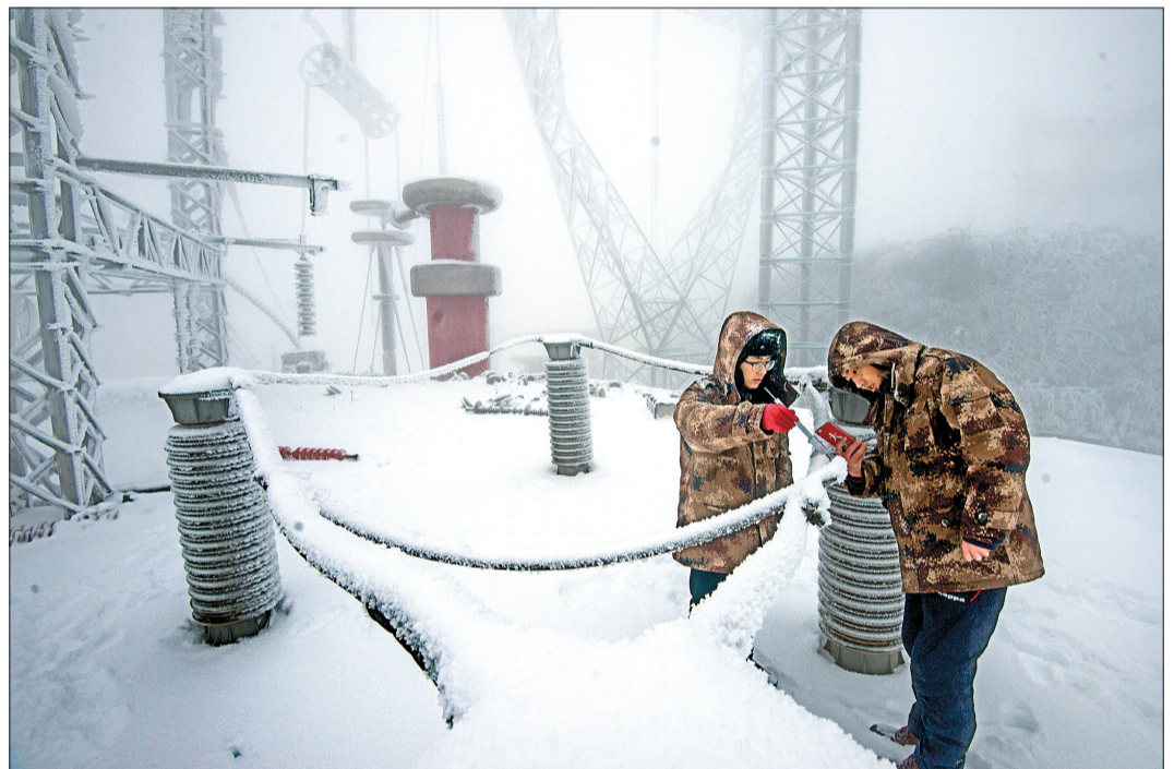
2018年12月31日,湖南省怀化市雪峰山,重庆大学野外覆冰试验基地。团队成员正在记录输电线路导线覆冰厚度。 重庆日报记者 龙帆 摄(资料图片)
