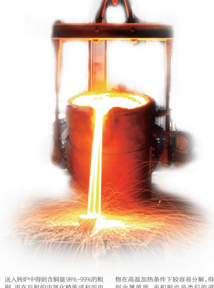
铜,再在反射炉内氧化精炼或利用电 解法得到精铜。现代湿法炼铜的成本 相对较低,但目前的技术无法满足工 业的产量需求,因此使用范围受到限 制,但湿法冶炼技术也正在逐步推广。
