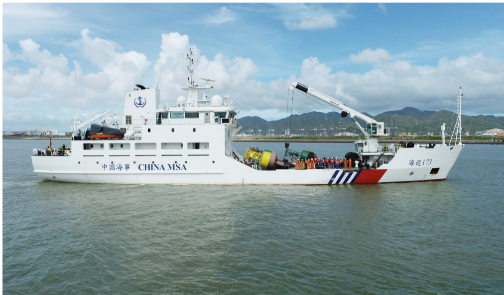
搭载北斗定位装置的大型航标船列编南海航保中心。这艘排水量2228吨的大型航标工作船是中国交通运输系统南海海区装备最先进的船,将用于粤港澳大湾区和南海海区水上浮标的布设和维护。
