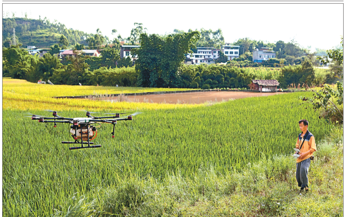
8月7日,永川区宝峰镇龙凤桥村,工作人员操作植保无人机喷洒农药。当日,当地种粮大户张昌文利用植保无人机为80多亩晚稻喷洒农药,进行三代螟虫和稻飞虱专业化统防统治。每台植保无人机每天能喷洒农药300余亩,既省时省力又减少用药量。 重庆日报特约摄影 陈仕川
