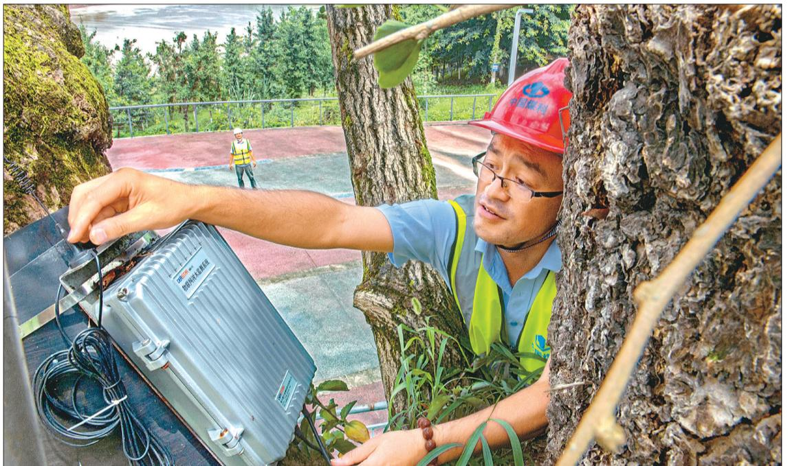
日前,在两江新区金海湾滨江公园,工程师对安装在一棵树龄400年银杏树上的物联网树木监测系统终端进行调试。
