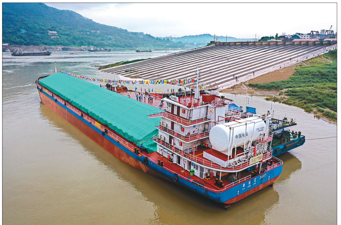
这是6月12日拍摄的停靠在重庆东风船厂码头的油气电混合动力内河船舶“新长江26007”轮。船舶尾部装载着LNG燃料罐(无人机照片)。
