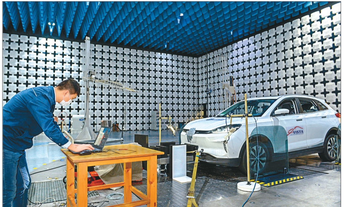
近日,在中国汽车工程研究院股份有限公司检测中心EMC试验室,工作人员正在对智能网联车的网联性能进行非道路测试评价。 重庆日报记者 张锦辉 摄
