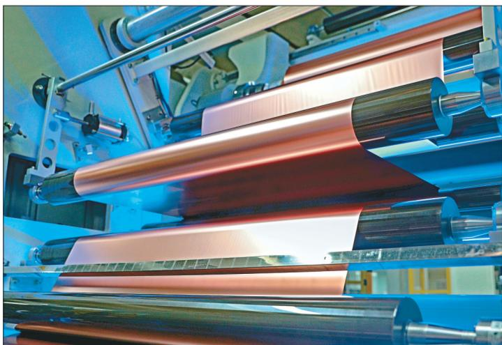
重庆弗迪锂电池有限公司,负极生产线自动化涂布设备正在运行。
