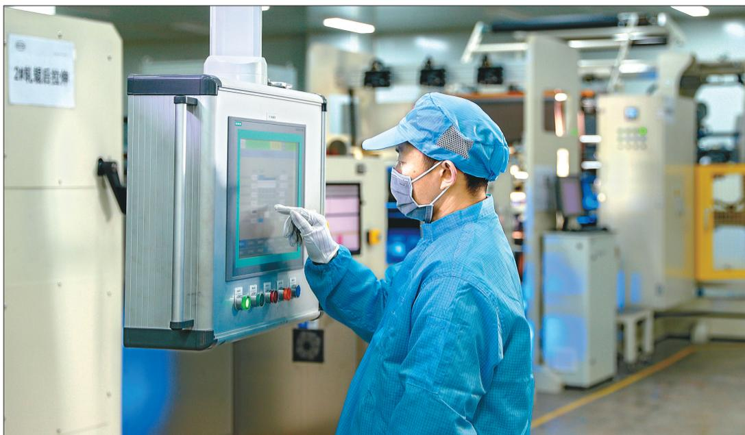
4月8日,重庆弗迪锂电池有限公司,工人正在负极生产线上操作收卷工序。
