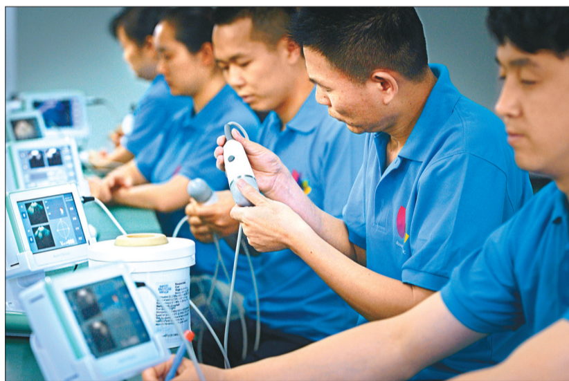
在位于两江新区大地企业公园的重庆康超医疗科技股份有限公司,工程师正在检测膀胱容量测定仪。
