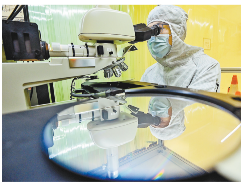
▲西部(重庆)科学城华润微电子,技术人员正在检查晶圆表面。 本版图片均由首席记者 龙帆 摄/视觉重庆
