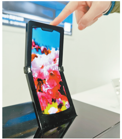
京东方重庆第6代AMOLED（柔性）显示产品样品。 记者 王天翊 摄/视觉重庆
