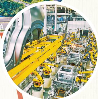
图②:江北区鱼复工业园重庆小康新能源汽车智能工厂,焊接机器人正在焊接车身。(本报资料图片)
