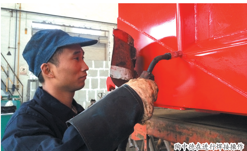
陶中德在进行焊接操作 则将出现车毁人亡的事故。为此，陶中德废寝忘食地钻研焊接攻克办法，经多次试验，最终采取“立式多次覆焊”，使焊接厚度和强度达到要求，为公司节约了成本，为用户创造了价值。 此外，他还在借鉴其他单位先进
