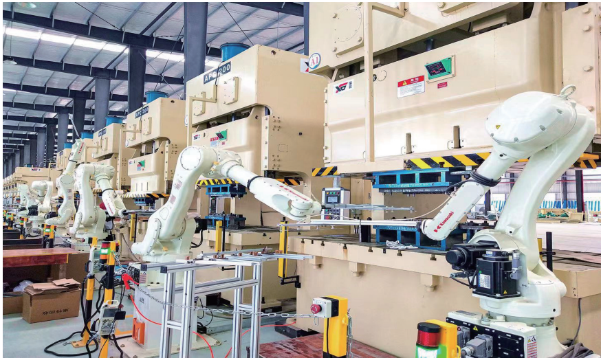
同昶科技全自动精密冲压线上，机械手臂的生产效率比传统人工提高10倍以上，精度可以达到微米级 摄/袁治卫
