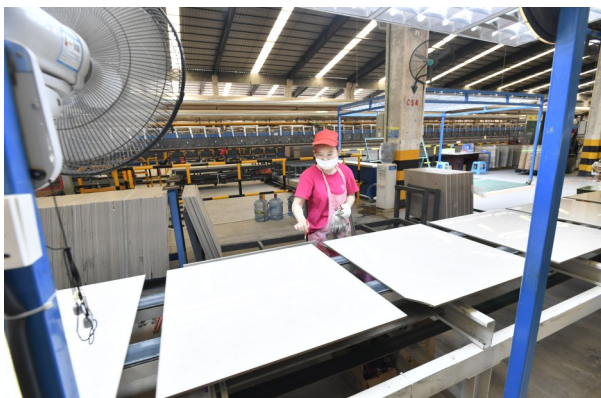
重庆唯美陶瓷有限公司地砖生产车间全自动智能检测工序
