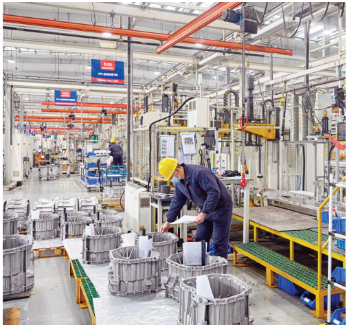
綦江齿轮传动有限公司自动装配生产线,检验人员在检验变速器壳体
