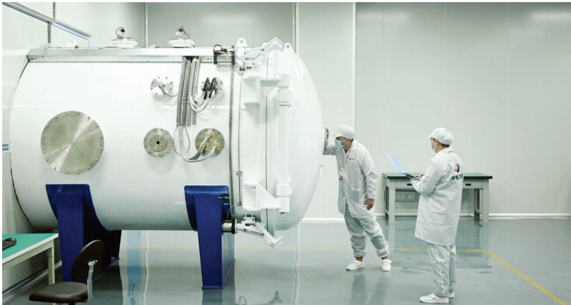
开拓卫星试验工程师对卫星电源产品进行热真空实验
