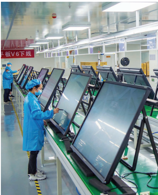
美艾(重庆)科技公司员工在组装智能会议平板电路板和触点精度校准
