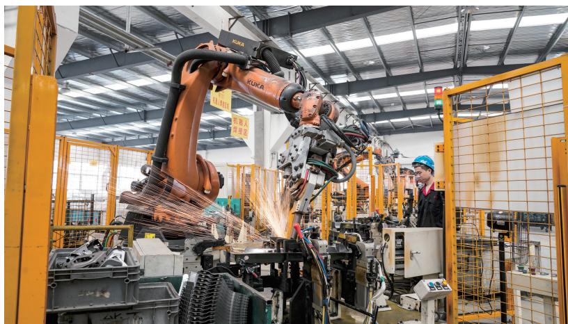
位于北碚区蔡家智慧新城的重庆能正机械有限公司，机器人在焊接汽车钣金件
